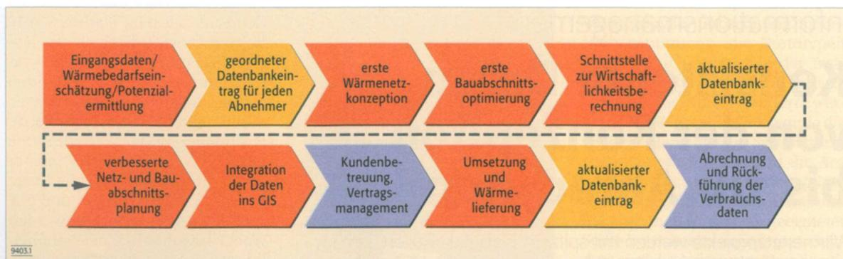
Bild 1. Stationen des fortlaufenden Datenmanagements bei der Planung sowie dem Bau und Betrieb von Wärmenetzen; die Farben der Pfeile zeigen die Zuständigkeit der Projektpartner; rot: IB News, gelb: Netcadservice, blau: Somentec
